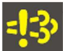
• контрольный неисправности выхлопной системы
