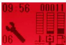
◀ В случае возникновения неисправности погрузчика, подсветка дисплея станет красной и отобразится соответствующая иконка неисправности, а ниже отобразится код неисправности.
