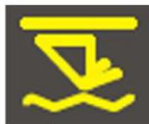
• контрольный индикатор плавающего режима
