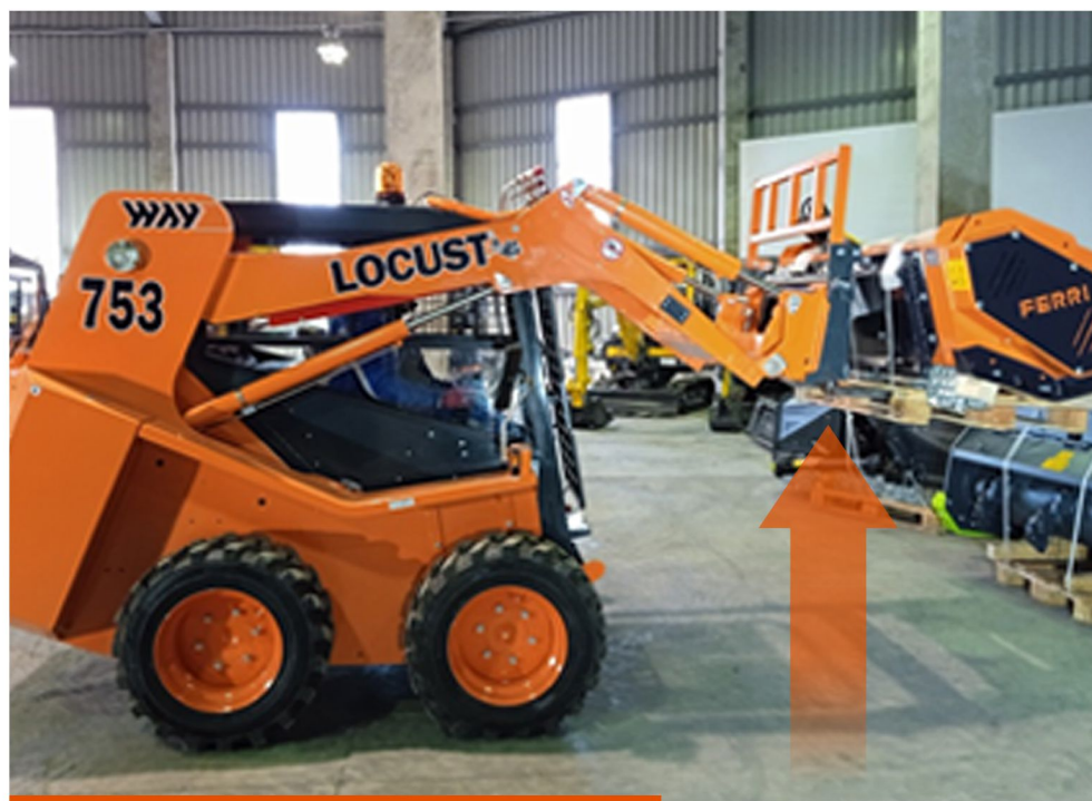
Locust L753 поднял 936 кг на высоту 1300 мм
