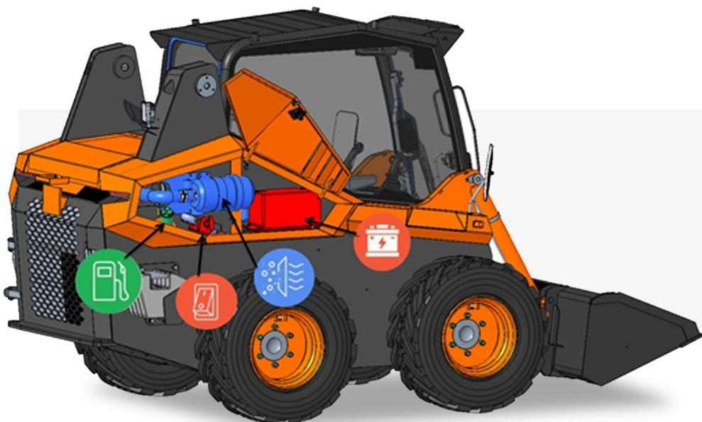
Левый отсек содержит охладитель гидравлического масла, бачок омывателя и заливную горловину гидравлического бака.
