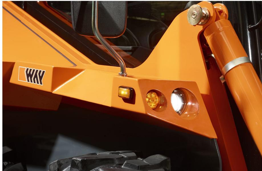
За счет заглубления передних фар в корпус крыла минипогрузчика, была достигнута лучшая защита от механических повреждений
